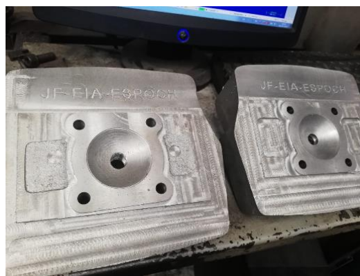
Figura 6. Comparación de cabezote de referencia con el prototipo.
