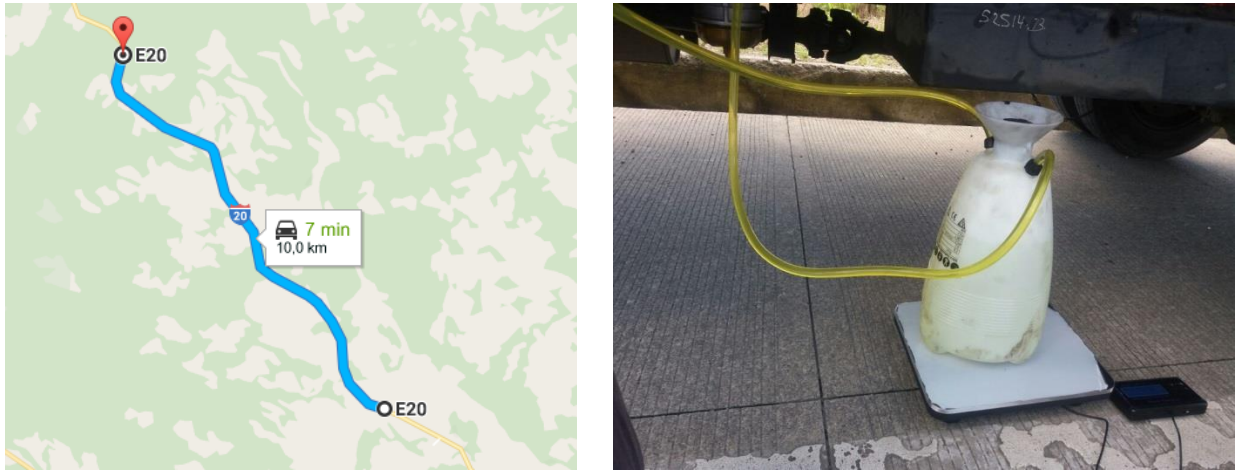
Figura 2. Ruta de prueba y la medición por gravimetría Fuente: Elaboración propia
