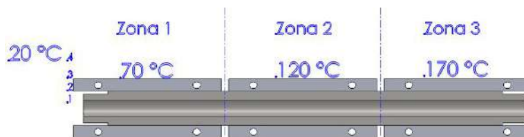
Figura 4. Transferencia de calor en el molde.
