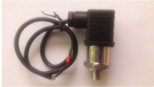
Figura 18. Sensor transmisor de presión HR-PTM300
