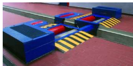
Fig. 2 Banco de prueba de potencia con rodillos LPS 3000 R200 2
