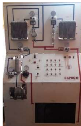
Figura 17. Banco de aires acondicionados automotrices.
