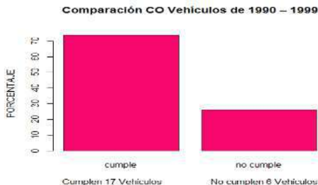
Figura 4: Comparación de las emisiones vehiculares de Monóxido de Carbono por año de fabricación 1990 – 1999 con la NTE INEN 2204.
