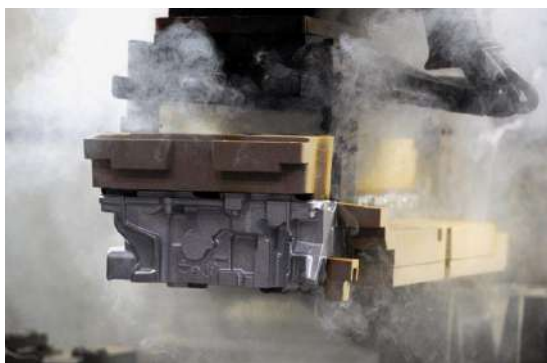
Figura 17. Desprendimiento de humo y olores de los núcleos moldeados mediante arena aglomerada orgánica, durante y posterior vaciado de un cabezote (Weissenbek et al., 2012).
