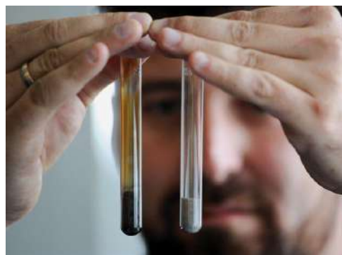
Figura 18. Tubo con arena aglomerada orgánica (izq.) existe desprendido de humo, tubo con arena inorgánica (dcha.) no muestra signos de humo. Los dos tubos fueron calentados a temperatura de vaciado (Weissenbek et al., 2012).
