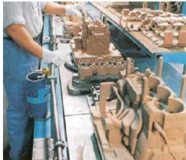
Figura 10. Núcleos de arena aglomerada orgánica sintética (European Aluminium Association, 2002)
