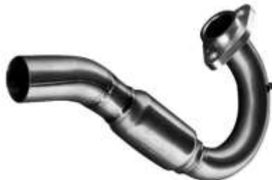
Figura 2. HEADER estándar de uso común en motocicletas de 200cc
