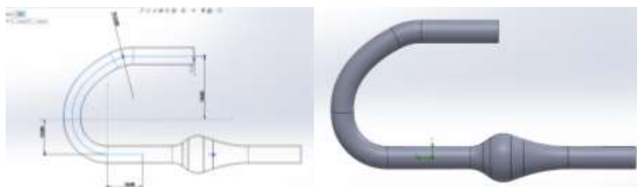
Figura 4. Croquis y extrucción del sólido caso B, con curvatura prolongada. Elaborado por: Autores
