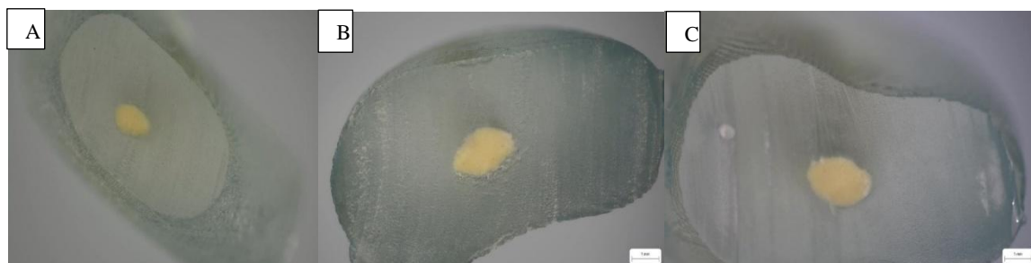
Figura 3. A) Imagen aumentada de parte apical de diente con AH plus sin gutapercha. B) Imagen aumentada del tercio medio del diente con AH plus sin gutapercha C) Imagen aumentada del tercio medio de diente con AH plus sin gutapercha.
