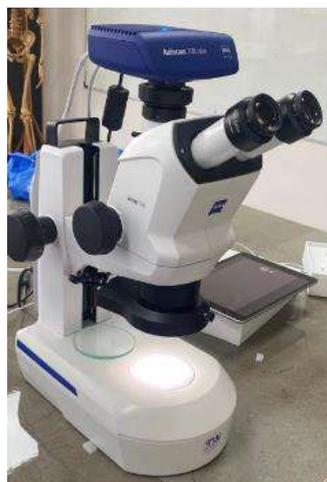
**Figura 5.** Estereomicroscopio Stemi 508 y cámara Axiocam 208 color, de la marca Zeiss
