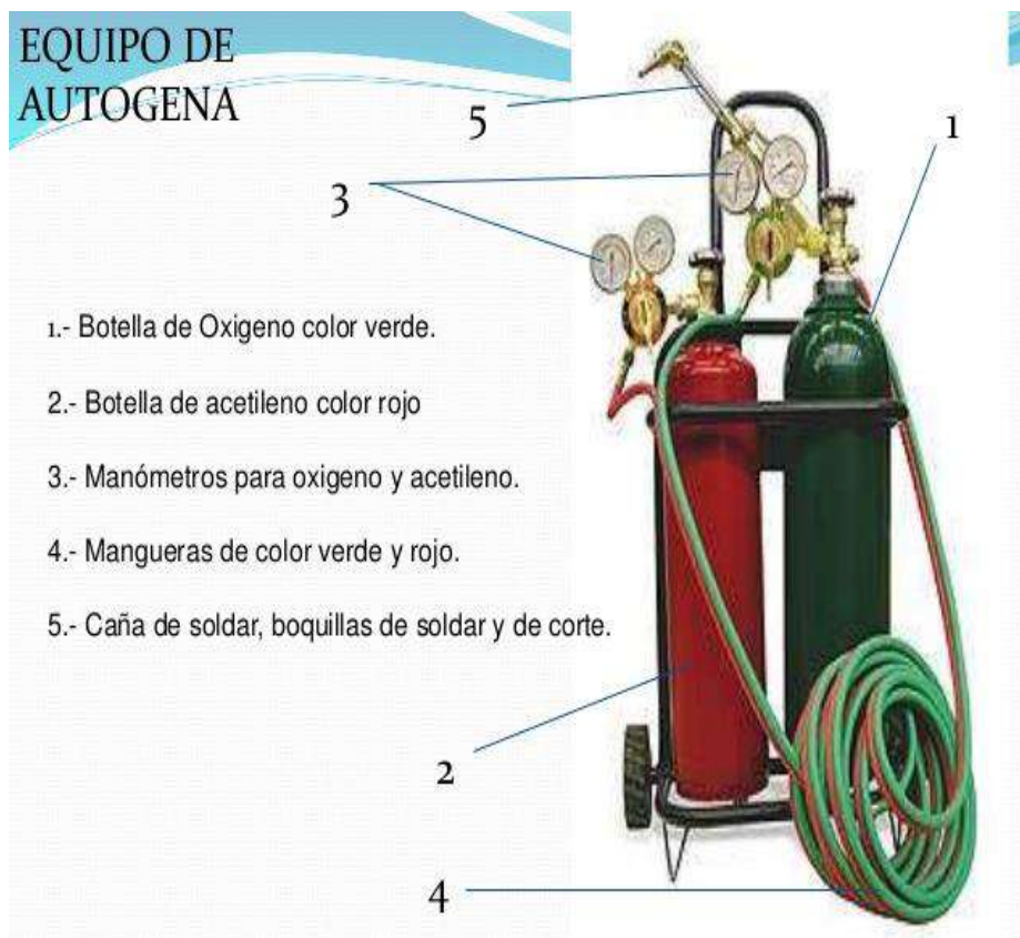
Figura 1. Equipo autógeno
