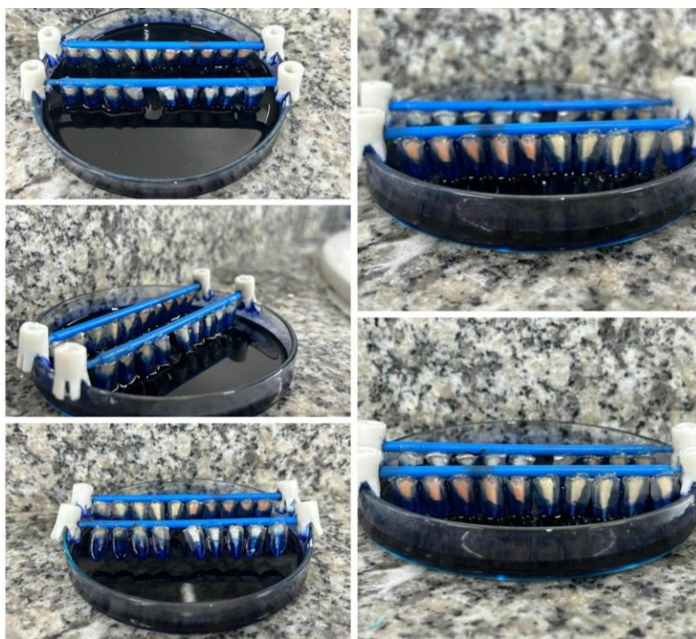
Figura 2. Dientes deacrílico obturados colocados dentro de azul de metileno.
